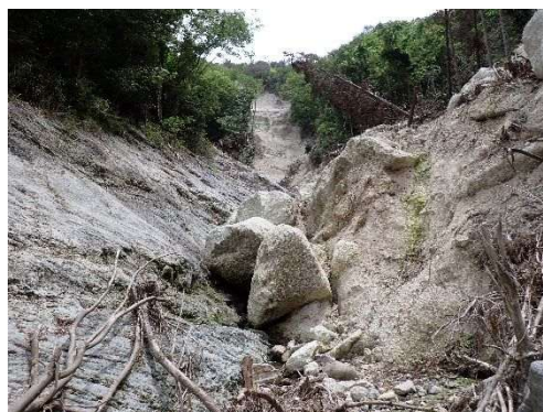
写真. 1 軽石質凝灰岩の転石と崩壊斜面
