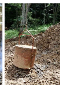
写真. 5 井内掘削・転石粉砕・排土回転バケット
