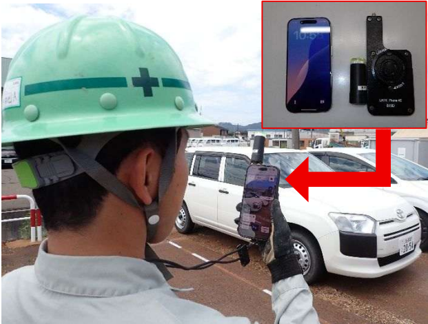
写真.2 使用機器一式(写真右上) および作業風景(例)
