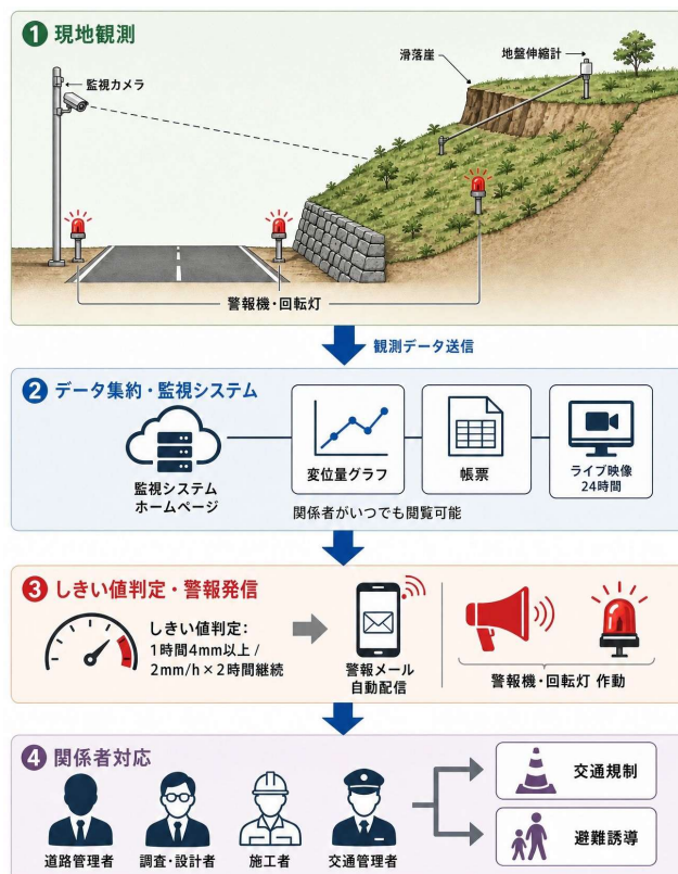
図.2 監視体制の概念図
