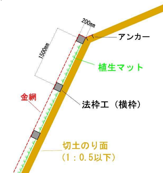
図.3 試験的に実施した食害対策工模式図
