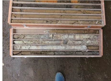
写真45 Aブロックボーリングコアのすべり面 付近にみられる白色の粘土層
