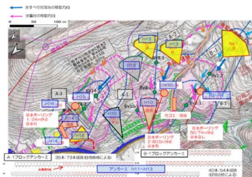
図6.10.2 既往地すべりブロックと地震で生じた地すべりブロック範囲及び対策工の変状発生状況 21)
