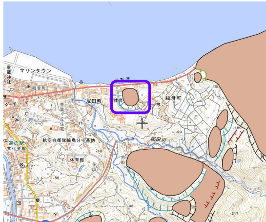
図6.1.4 稲舟地区周辺の地すべり地形分布（防災科学技術研究所HP 12) 、四角囲み部分が概ね「グラウンドブロック」に相当する）
