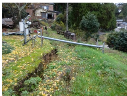
写真6.1.3 伸縮計で監視されている連続性のある段差（水田ブロック群エリア）
