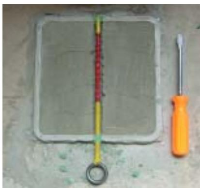
写真 4 拘束具設置状況(グラウト充填前)
