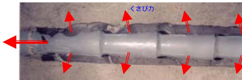
写真 3 アンカー体拘束具作動状況(超過荷重時、定着地盤強度  $q_u = 11.7\text{Mpa}$ )
